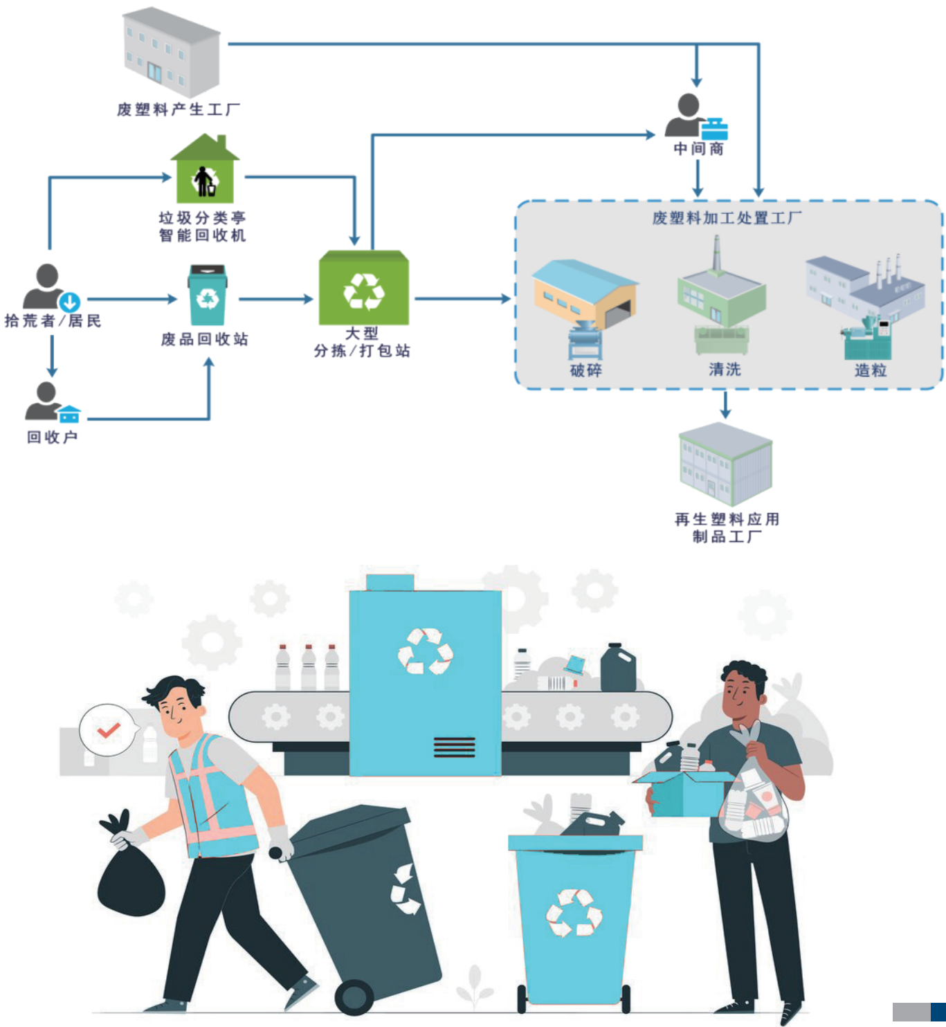
图：废 PET/HDPE 瓶的回收加工流程
