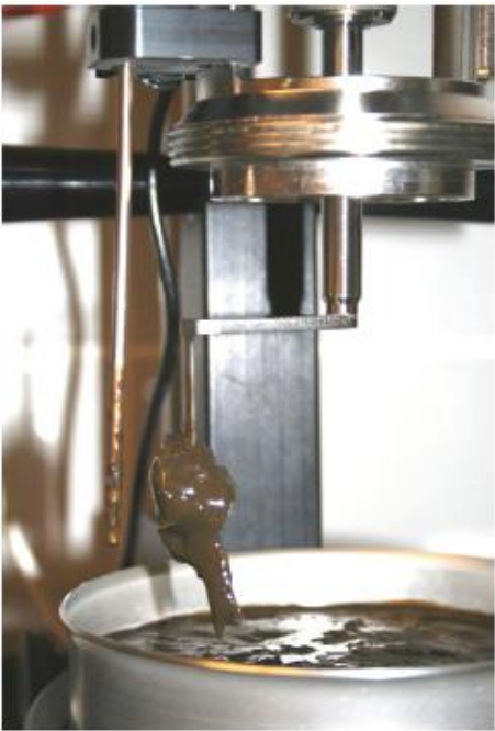
图 37: 固体粘附在球体表面上(资料来源: 布雷默)
