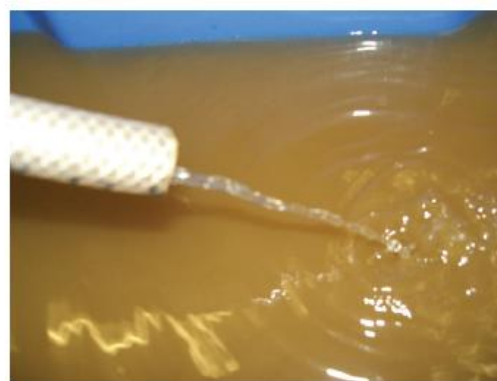
图 67：完成湿筛法后的溢流（资料来源：施耐德[Schneider], 2010）
