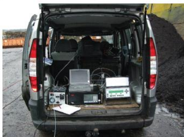
配设采样泵与分析仪的排气测量技术以及在线获取测量值。
