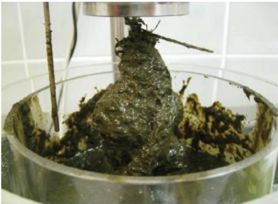
图 35：长纤维底物组分缠绕搅拌器轴（资料来源：布雷默）
