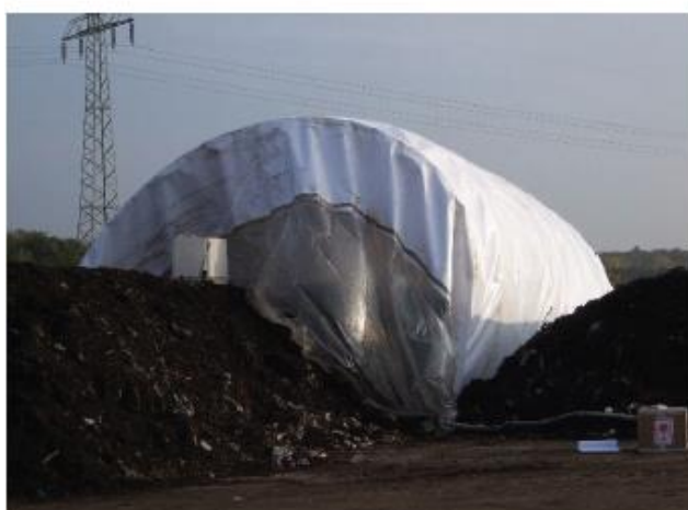
使用采样软管从风洞中排出废气（风洞后视图）
