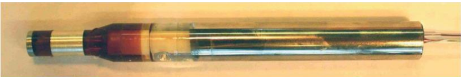
图 15：电流型氢传感器（资料来源:KSI）
