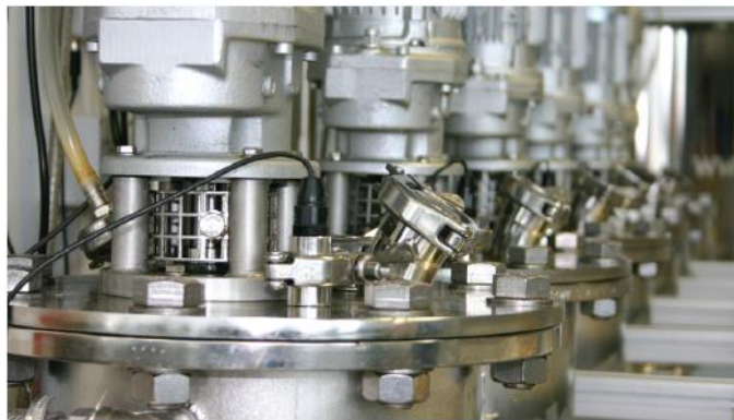
图 74：在弗劳恩霍夫陶瓷技术和系统研究所开展的连续实验室消化进程
