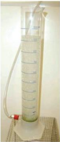
图 27：采用泡沫发生模型的泡沫发生装置
