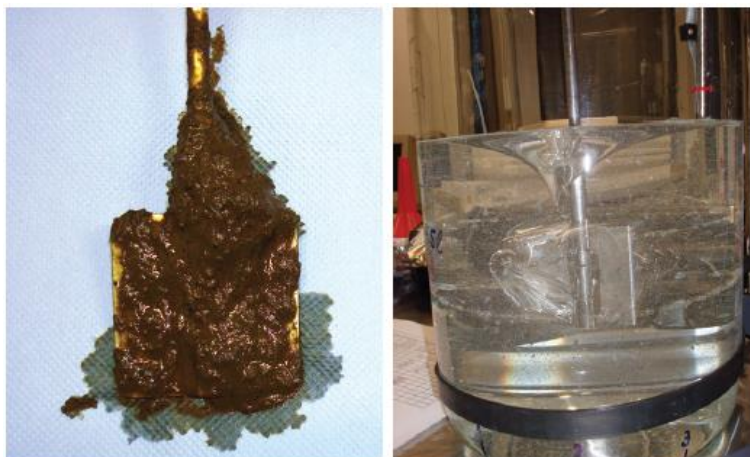
图 48：底物缠绕叶片搅拌器并产生涡流（资料来源：陶瓷技术和系统研究所）
