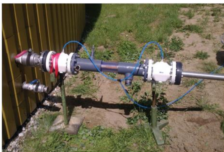
图 50：用于传感器冲洗和密封的锁止腔示例（资料来源：柏林工业大学）
